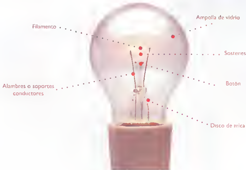
Figura 4.2. Estructura de una lámpara incandescente
